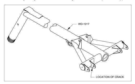
FIGURE 1: INBOARD LUG CRACK LOCATION
